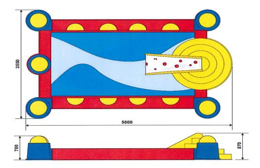
La pataugeoire est composée d'un bac et de deux éléments latéraux. Elle a une surface d'environ 20 m2 pour une profondeur d'eau de 20 cm. Elle est munie d'un mini escalier avec mini toboggan intégrés dans la structure. Elle comporte également des assises sur le côté et 5 emplacements pour pouvoir installer des jeux interactifs.
